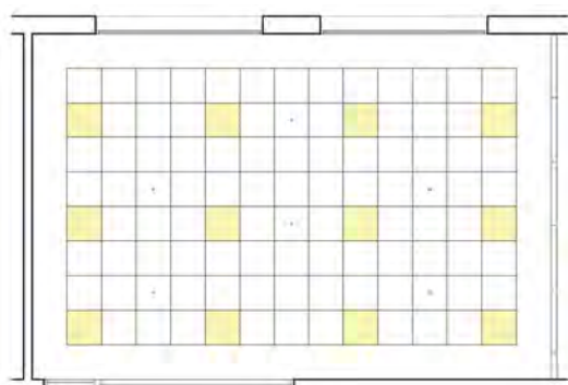
Disposición de las luminarias en un aula tipo.
